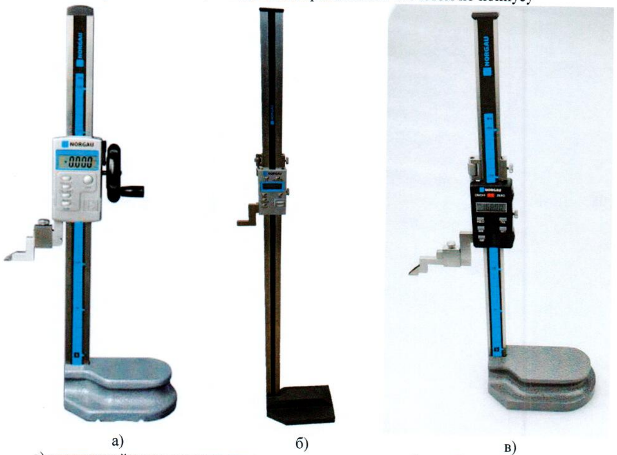
а) штангенрейсмасы с металлическим корпусом дисплейного блока и с маховиком; б) штангенрейсмасы с металлическим корпусом дисплейного блока и без маховика; в) штангенрейсмасы с пластиковым корпусом дисплейного блока.
