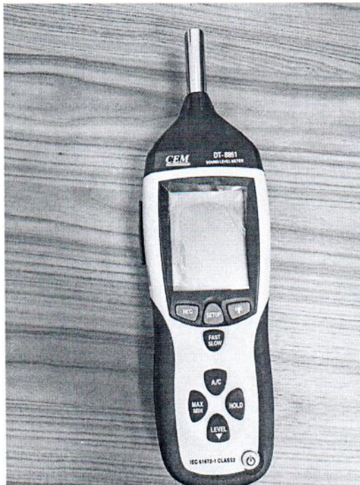
Рисунок 1.1 – Фотография общего вида измерителя уровня звука DT- 8851 № 12044600
