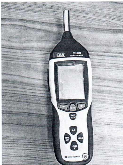
Рисунок 1.1 – Фотография общего вида измерителя уровня звука DT- 8851 № 12036180
