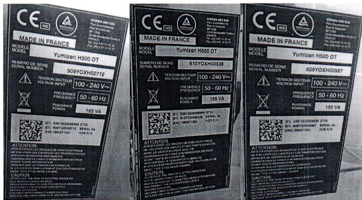
Рисунок 1.2 – Фотография маркировки анализатора гематологического автоматического YUMIZEN (YUMIZEN H500 OT) (изображение носит иллюстративный характер)
