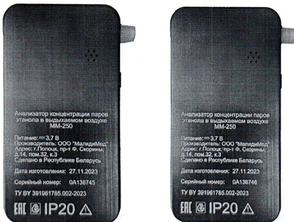
Рисунок 1.4 – Образец маркировки анализаторов концентрации паров этанола в выдыхаемом воздухе MM-250 (изображение носит иллюстративный характер)
