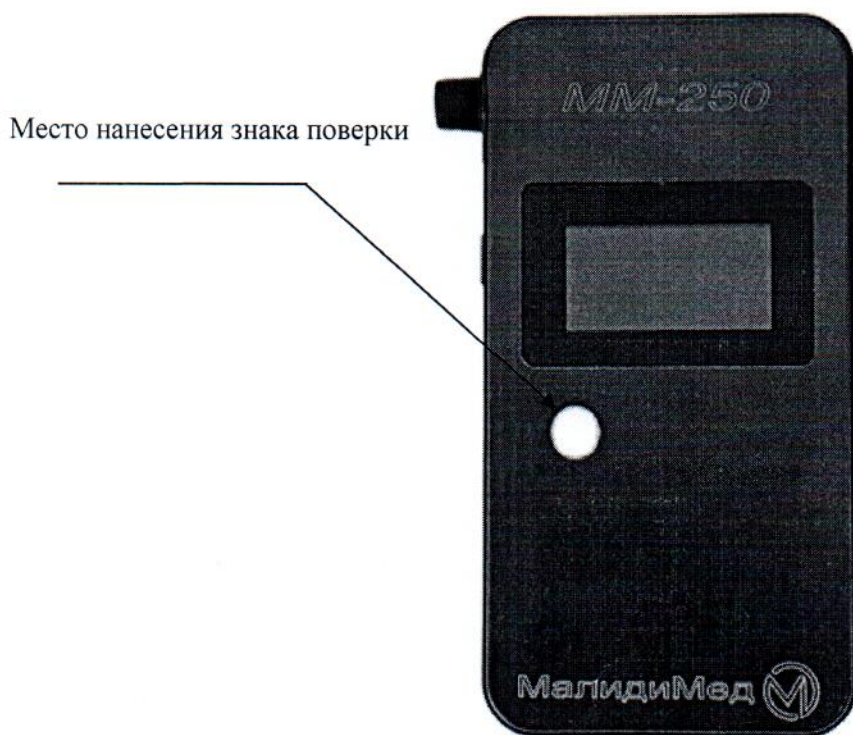
Рисунок 2.2 – Схема (рисунок) с указанием места для нанесения знака поверки на анализатор MM-250
