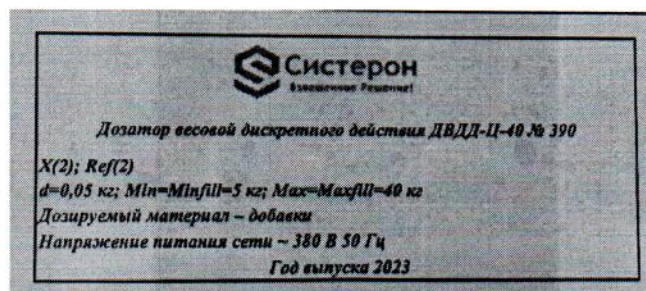
Рисунок 1.2– Маркировка дозатора весового дискретного действия ДВДД-Ц-40 № 390
