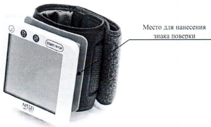
Рисунок 2.3 – Схема (рисунок) места нанесения знака клейма-наклейки прибора для измерения артериального давления и частоты пульса цифрового WS-1011
