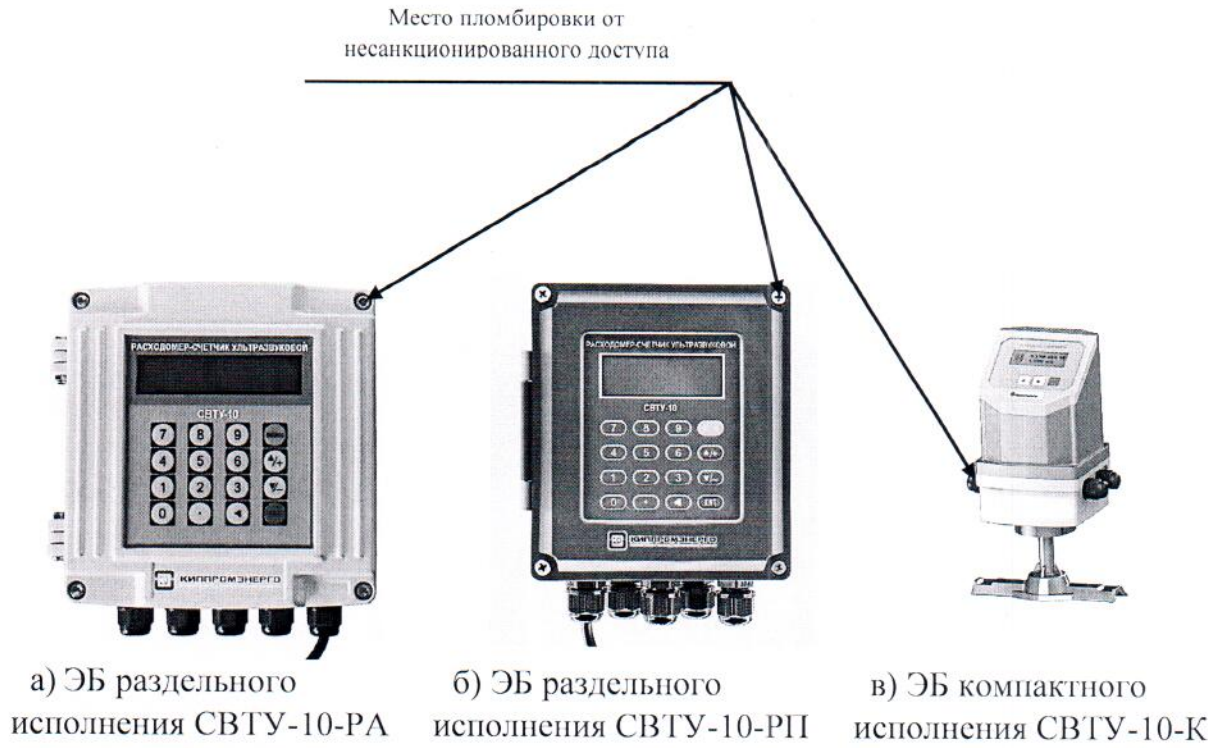
Рисунок 3.1 – Схема пломбировки от несанкционированного доступа
