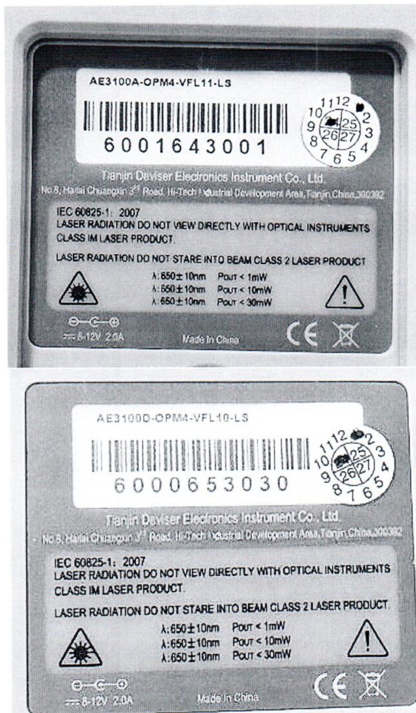
Рисунок 1.2 – Фотографии маркировки рефлектометров оптических AE3100
