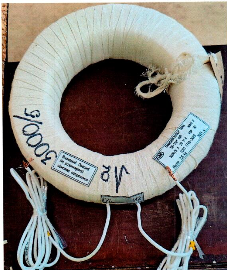
Рисунок 1.1 – Внешний вид трансформаторов тока ТВ-110* (изображение носит иллюстративный характер)
