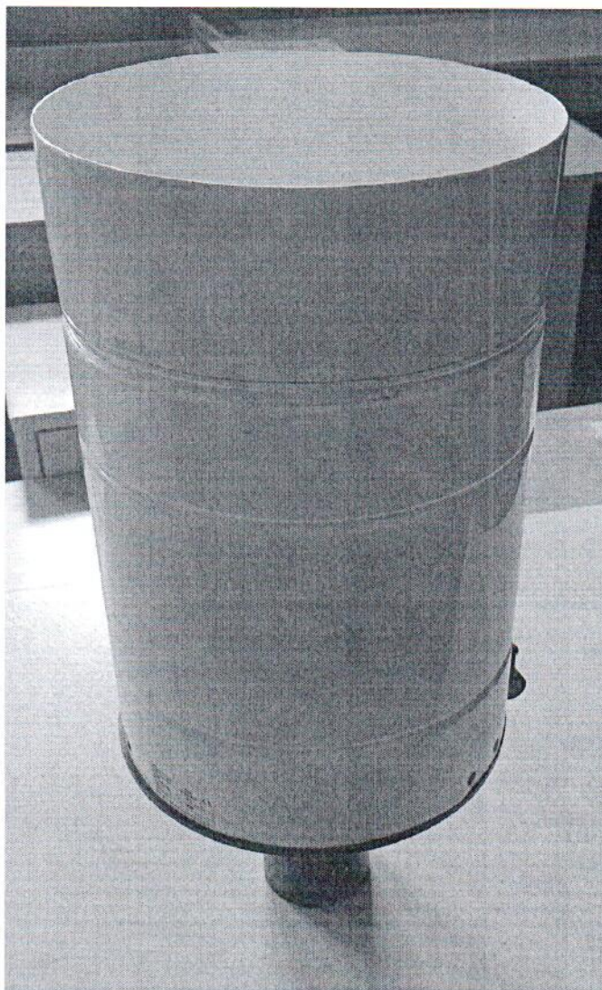
Рисунок 1.1 – Общий вид датчика осадков PL400R-N № 1013217
