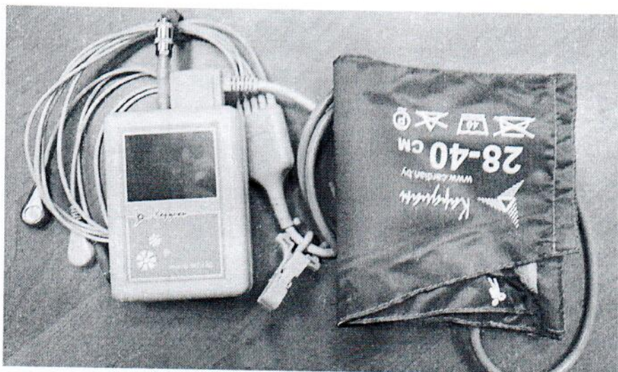
Рисунок 1.4 – Фотография общего вида монитора системы длительного мониторинга электрокардиограмм и артериального давления «КАРДИАН-СДМ» «КАРДИАН ЭКГ и АД» (изображение носит иллюстративный характер)
