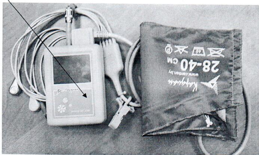
Рисунок 2.1 – Схема (рисунок) с указанием места для нанесения знака поверки на систему длительного мониторинга электрокардиограмм и артериального давления «КАРДИАН-СДМ» «КАРДИАН ЭКГ и АД»
