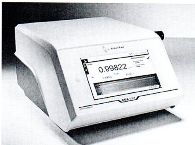
Рисунок 1.1 – Фотография общего вида плотномеров DMA 1001 (изображение носит иллюстративный характер)
