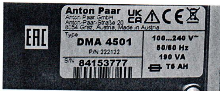
Рисунок 1.4 – Фотография маркировки плотномеров DMA4101, DMA 4501 (изображение носит иллюстративный характер)
