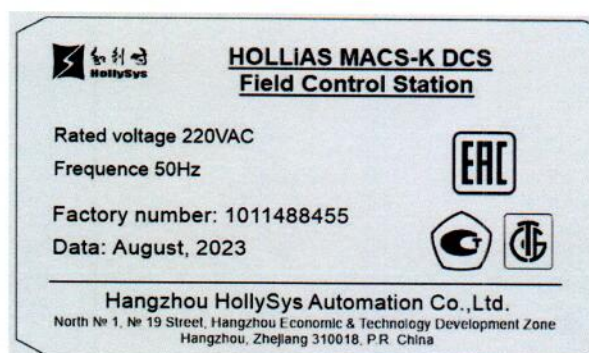
Рисунок 1.2 – Внешний вид маркировки станции управления (изображение носит иллюстративный характер; маркировочная табличка размещается на внутренней стороне электротехнического шкафа станции управления на двери или боковой стенке)
