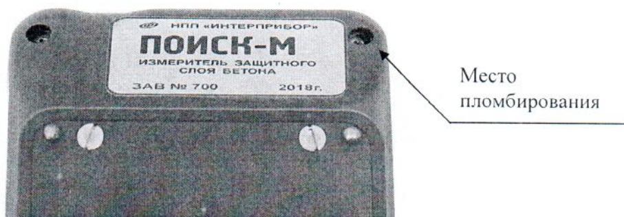
Рисунок 1 - Место нанесения пломбировки от несанкционированного доступа на панели электронного блока приборов ПОИСК-М
