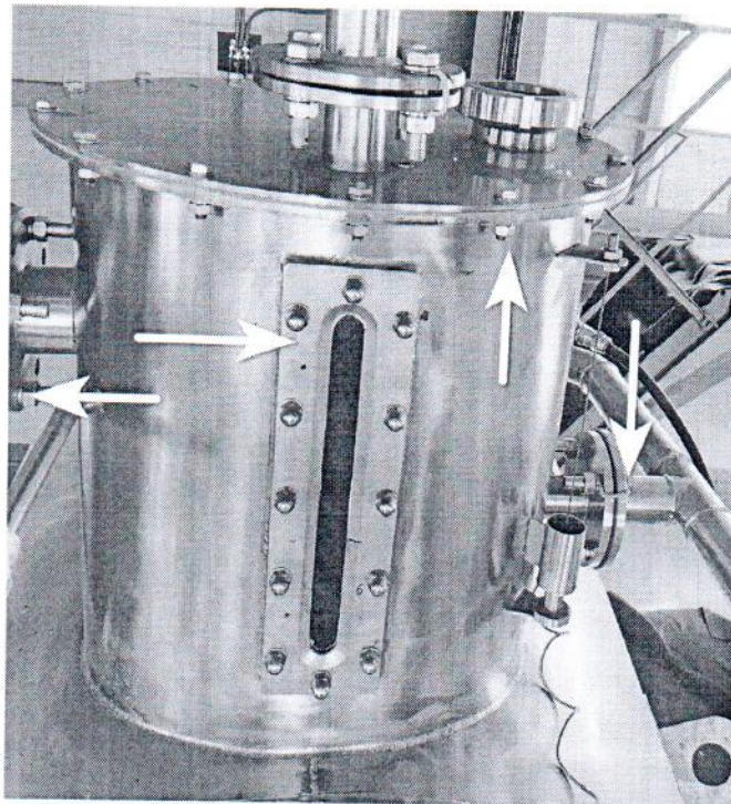
Рисунок 3.1 – Схема пломбировки крыши-фланца, фланцев наливной и переливной труб и шкальной пластины от несанкционированного доступа
