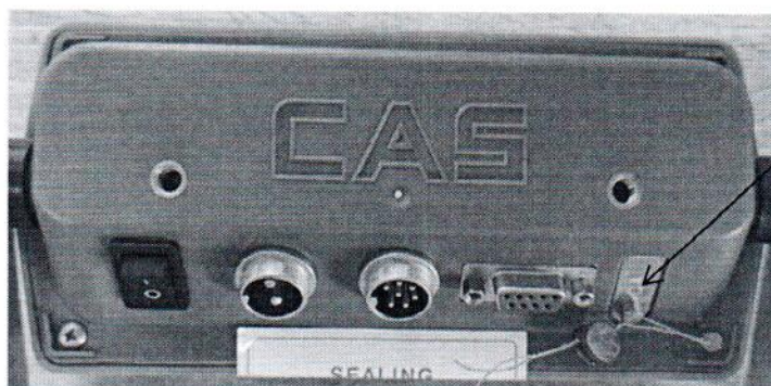
Рисунок 3.1 – Фотография с указанием места пломбировки от несанкционированного доступа в виде давления на пломбу на тыльной стороне индикатора весового CAS CI-2001A
