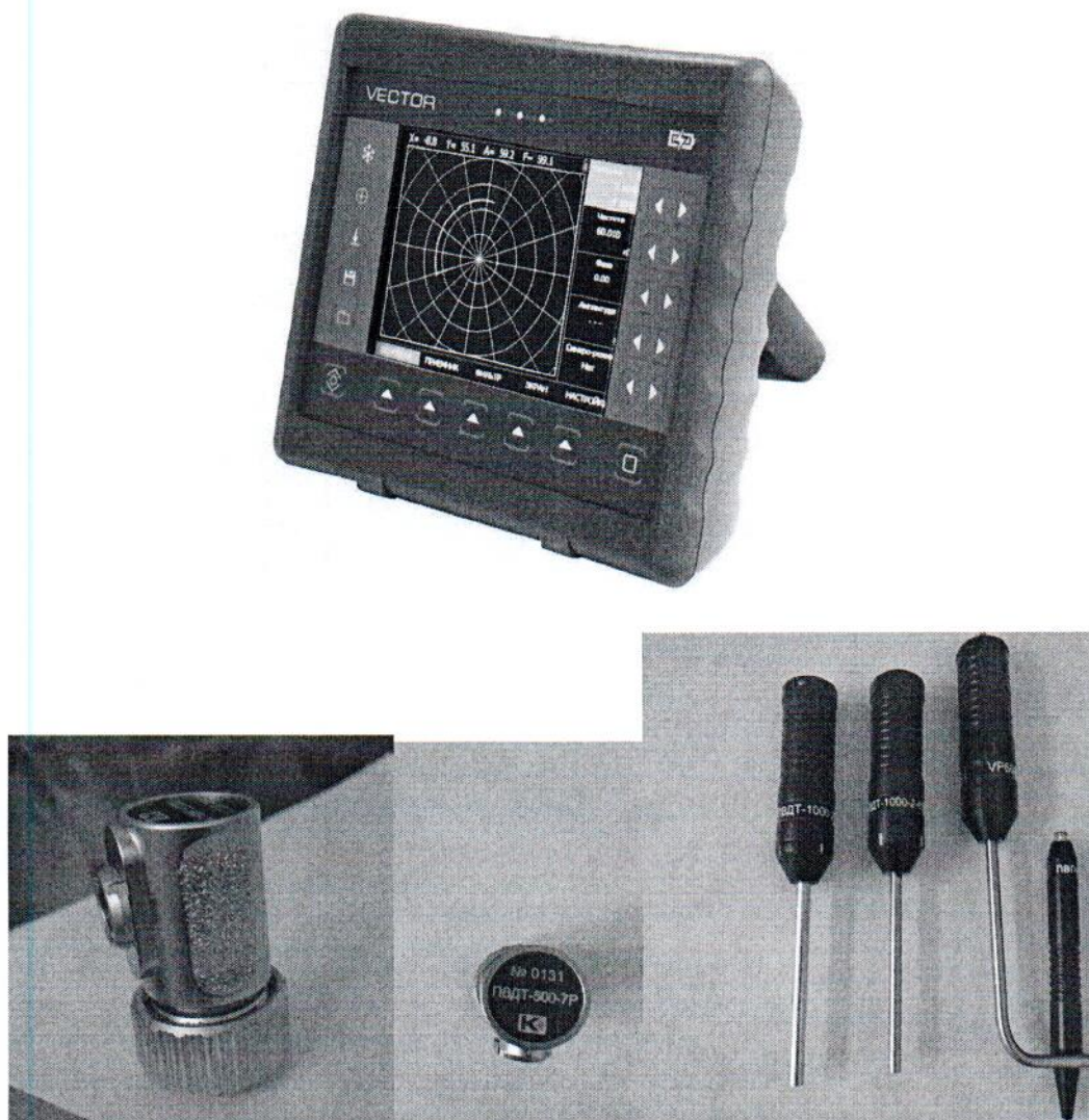
Рисунок А.1 – Внешний вид дефектоскопов ВЕКТОР-50 (электронный блок и преобразователи вихрековые)
