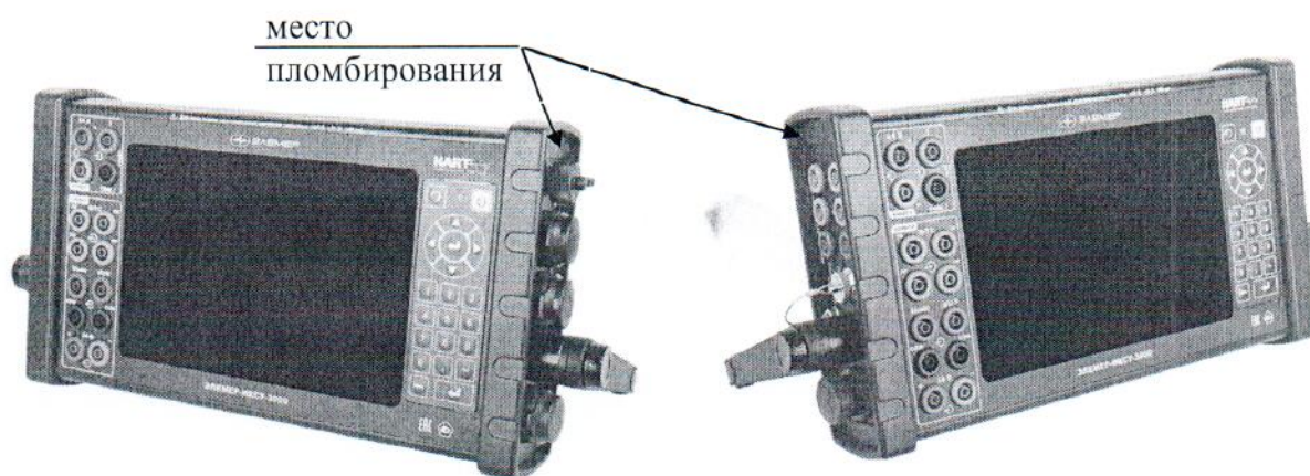
Рисунок 3 – Схема пломбировки от несанкционированного доступа
