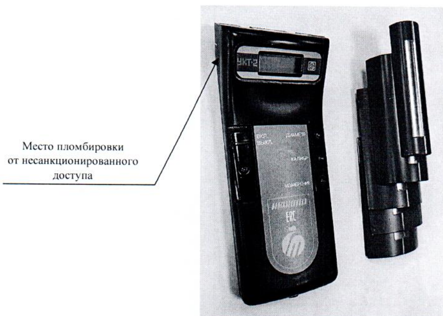
Рисунок 3.1 – Схема пломбировки от несанкционированного доступа
