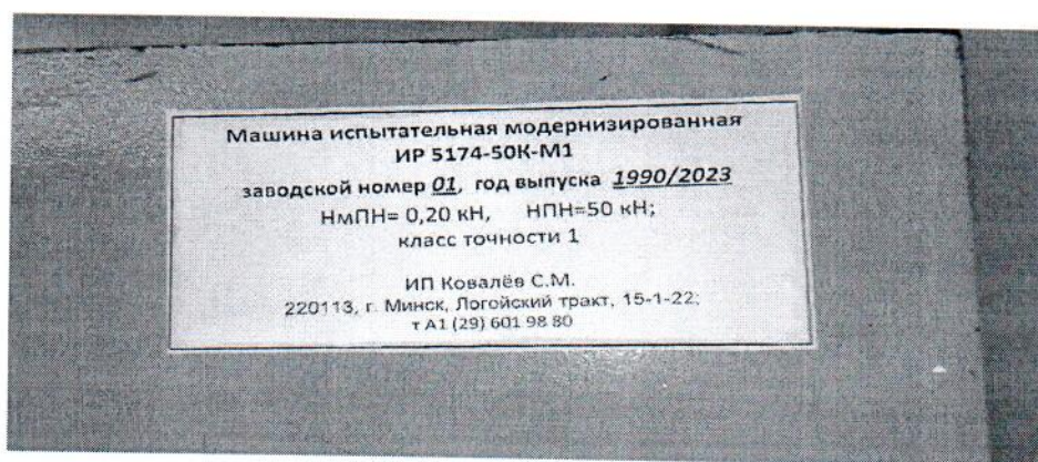
Рисунок А2. Индефикационная табличка машины испытательной модернизированной ИР 5174-50к-М1
