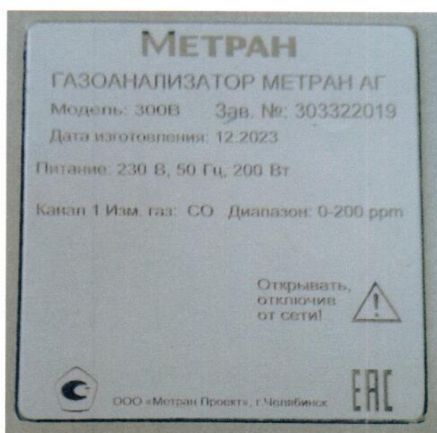
Рисунок 1.2 – Фотография маркировки газоанализатора МЕТРАН АГ 300В № 303322019
