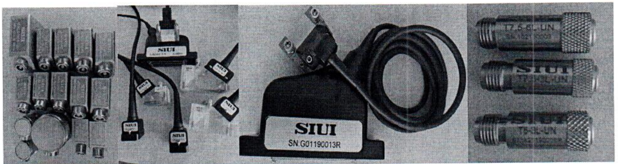
Рисунок 1.2 - Фотографии общего вида модификаций SyncScan PA16:64PR/TOFD/UT, SyncScan PA32:128PR/TOFD1/UT2, SyncScan PA32:128PR/TOFD2/UT2 дефектоскопов ультразвуковых SyncScan (электронный блок дефектоскопа и преобразователи ультразвуковые)
