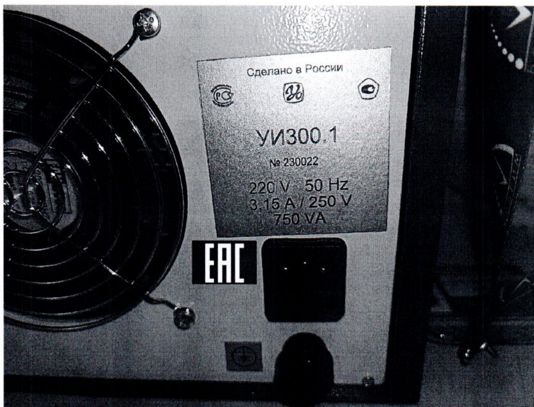
Рисунок 1.2 – Фотография маркировки устройства для питания измерительных цепей постоянного и переменного токов УИ300.1 № 230022
