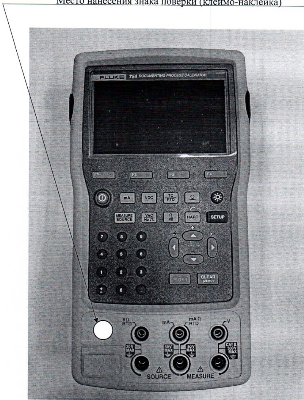
Рисунок 5 – Место для нанесения знака поверки в виде клейма-наклейки
