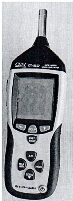
Рисунок 1.1 – Фотография общего вида измерителя уровня звука DT- 8852 № 150816188
