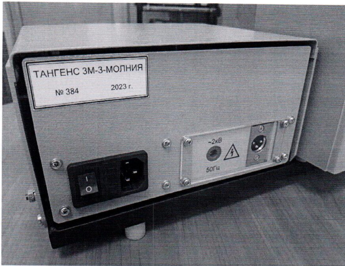
Рисунок 3 - Фотография нанесения маркировки установки измерения диэлектрических потерь жидких диэлектриков ТАНГЕНС 3М-3-МОЛНИЯ № 384
