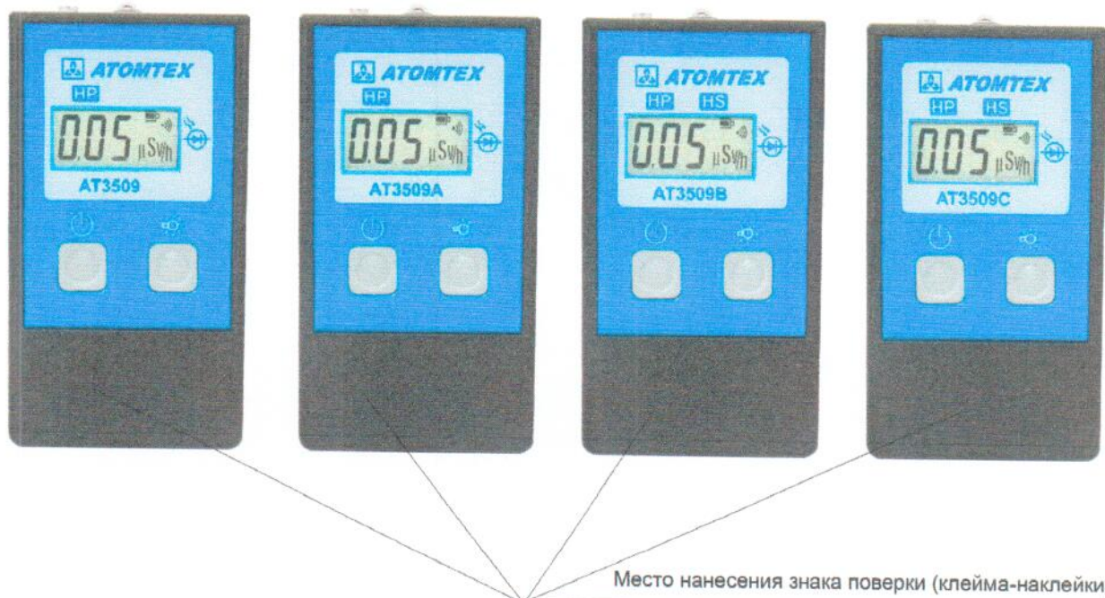
Рисунок 3 – Место нанесения знака поверки (клейма-наклейки)
