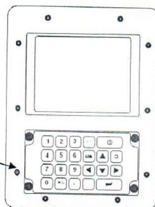
Рисунок 2 - Схема пломбировки расходомеров-счетчиков ультразвуковых переносных «ВЗЛЕТ ПРЦ»
