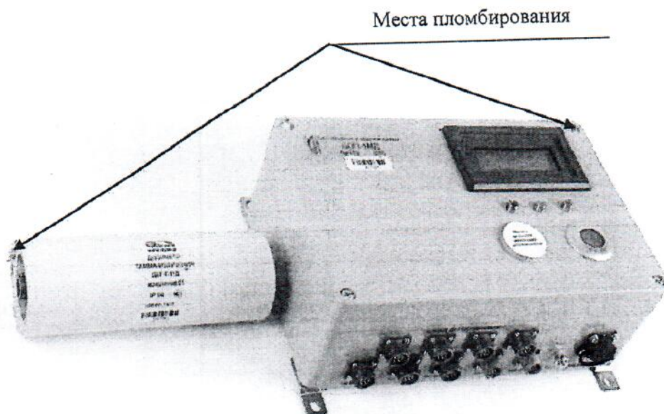
Рисунок 2 – Общий вид дозиметров исполнений 04, 05 (в состав которых входят дозиметры 01 или 02 исполнения соответственно и блок передачи данных БОП-1МД) и схема пломбировки от несанкционированного доступа
