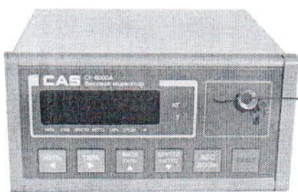
Рисунок 2 — Общий вид и место пломбировки индикаторов СКИ-12
