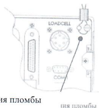
Рисунок 5 — Общий вид и место пломбировки индикаторов CI-600A Знак поверки наносится на свидетельство о поверке (в соответствии с действующим законодательством).
