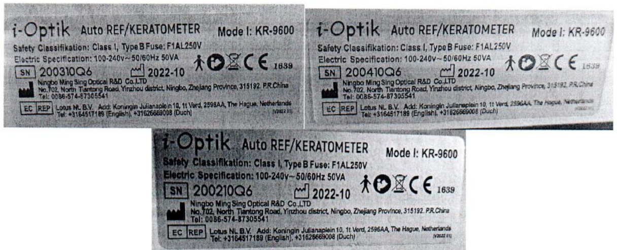
Рисунок 1.2 – Фотография маркировки авторефкератометра KR-9600
