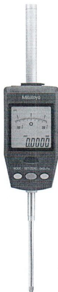
Рисунок 1.1 – Внешний вид головки измерительной цифровой Digimatic ID-H0560 № 22020559
