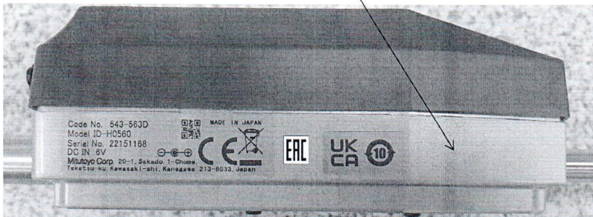
Рисунок 2.1 – Схема (рисунок) с указанием места для нанесения знака поверки средств измерений
