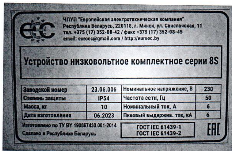
Рисунок 1.2 – Фотография маркировки устройств 8S (изображение носит иллюстративный характер)
