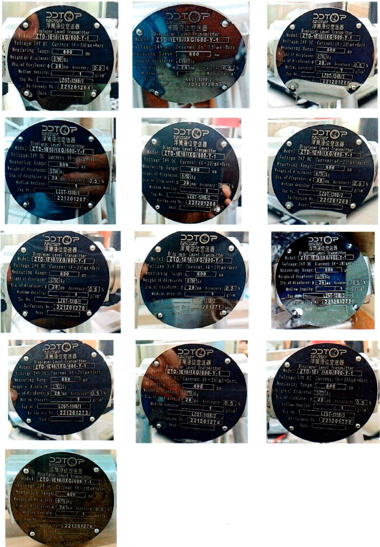
Рисунок 1.2 – Фотографии маркировки уровнемеров, представленных на испытания в целях утверждения типа средств измерений (маркировочная табличка на корпусе торсионной трубки уровнемера)
