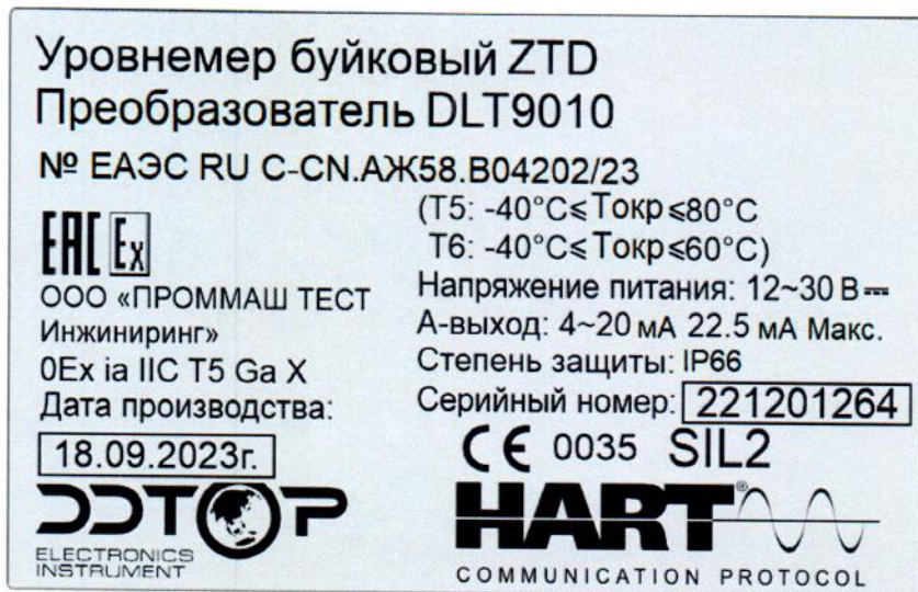
Рисунок 1.3 – Внешний вид маркировки уровнемеров (маркировочная табличка на корпусе электронного преобразователя DLT9010 уровнемера, изображение носит иллюстративный характер)
