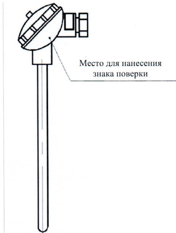
Рисунок 2.1 – Схема (рисунок) с указанием места для нанесения знака поверки средств измерений на термопары с клеммной головкой
