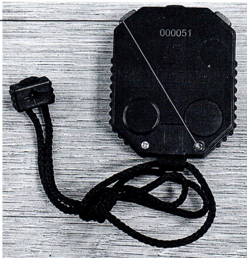
Рисунок 3.1 – Схема пломбировки от несанкционированного доступа
