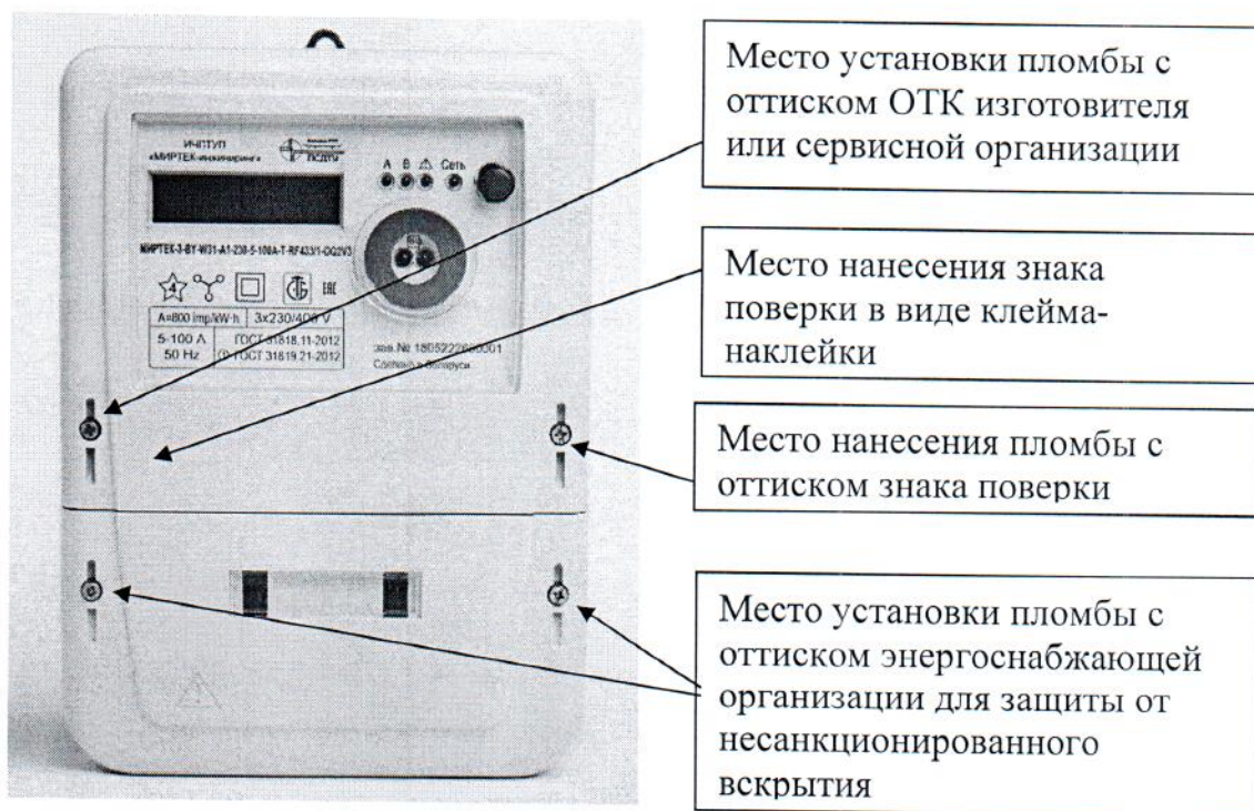
Рисунок Б.1. Места установки знака поверки средств измерений и пломбировки от несанкционированного доступа
