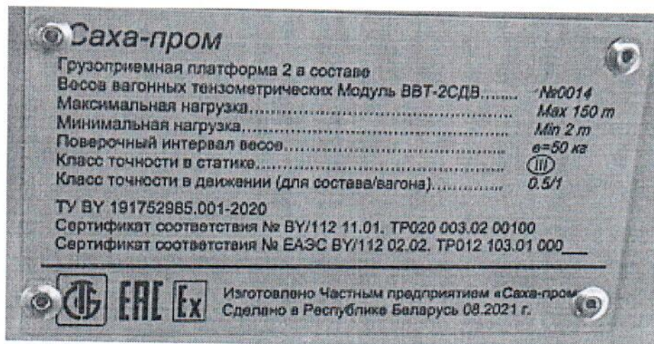
Рисунок 1.3 – Фотография маркировки грузоприемных платформ весов вагонных тензометрических Модуль ВВТ (изображение носит иллюстративный характер)
