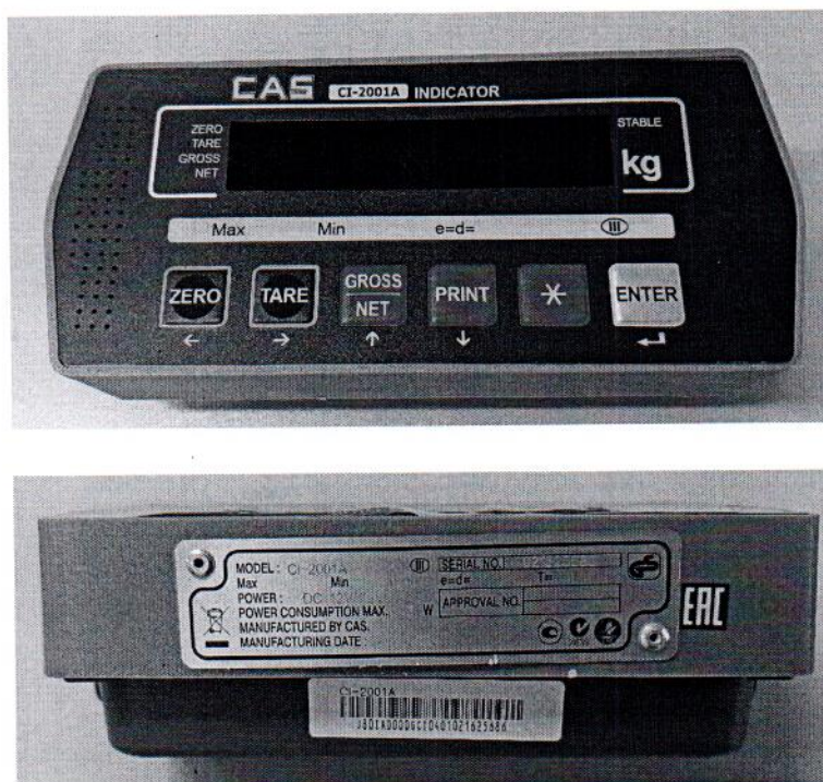
Рисунок 1.2 – Общий вид преобразующего устройства типа С (устройство весоизмерительное типа CI-2001А)
