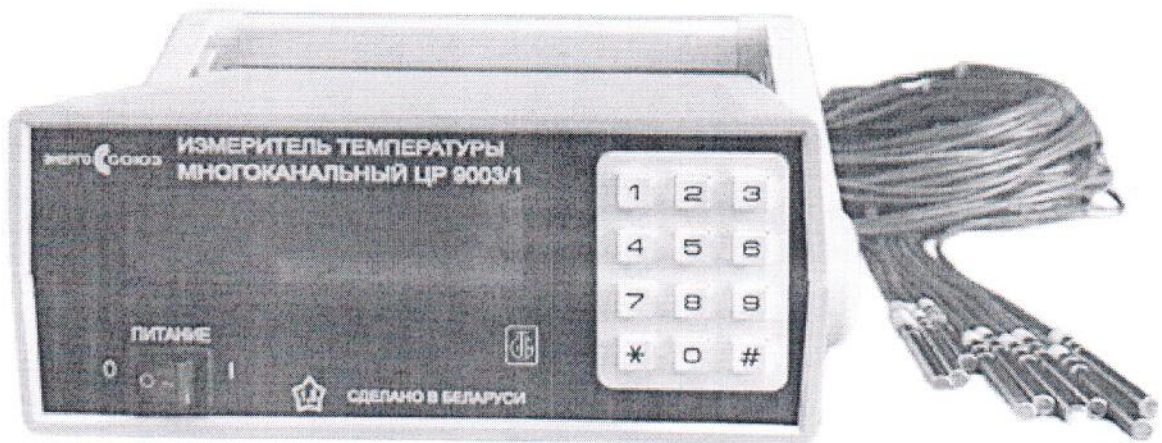
Рисунок 1.1 – Фотография измерителя температуры многоканального ЦР 9003/1
