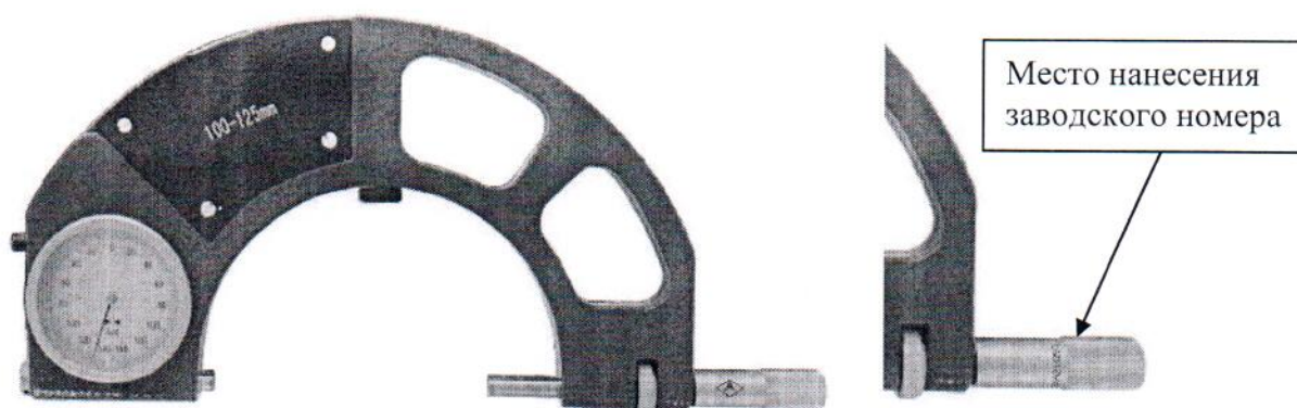
Рисунок 2 – Общий вид скоб с указанием места нанесения заводского номера
