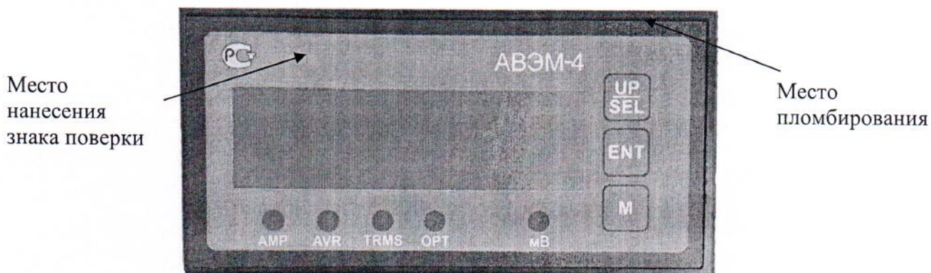
Рисунок 1 - Общий вид передней панели приборов измерительных АВЭМ-4 и схема пломбировки от несанкционированного доступа
