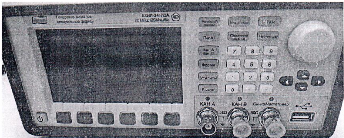
Рисунок 1.2 – Фотография общего вида передней панели генератора сигналов специальной формы АКИП-3407/2А № 1G5070014
