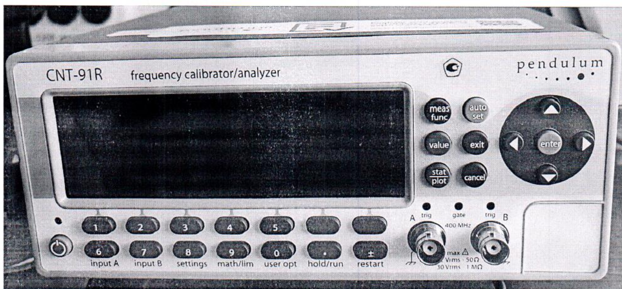
Рисунок 1.1 – Фотография общего вида частотомера универсального CNT-91R № 548399
