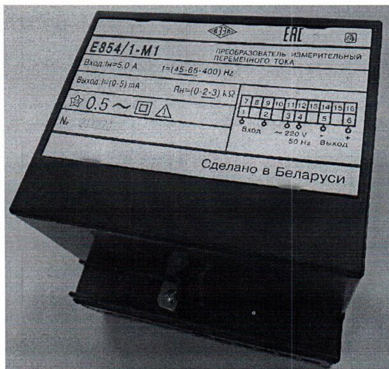
Рисунок 1 – Общий вид и маркировка ИП E854/1-M1 для нужд народного хозяйства
