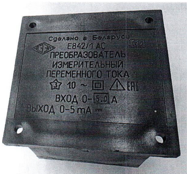
Рисунок 2 – Общий вид и маркировка ИП E842/1 AC для поставки на атомные станции
