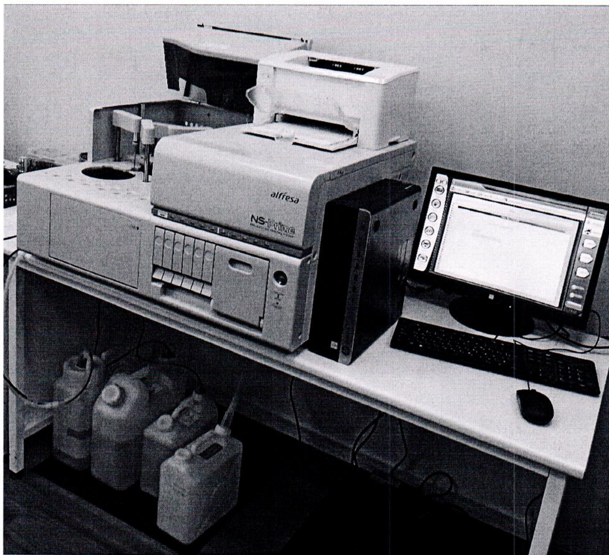
Рисунок 1.1 – Фотография общего вида анализатора биохимического автоматического дискретного с принадлежностями и материалами расходными: анализатор дискретный автоматизированный клинической химии NS-Prime для количественного in vitro определения и мониторинга концентрации аналитов в биологических жидкостях человека, с принадлежностями (изображение носит иллюстративный характер)
