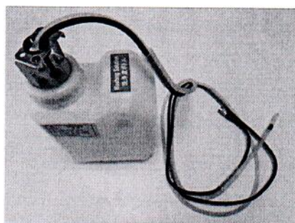
Ёмкость для промывающего раствора
